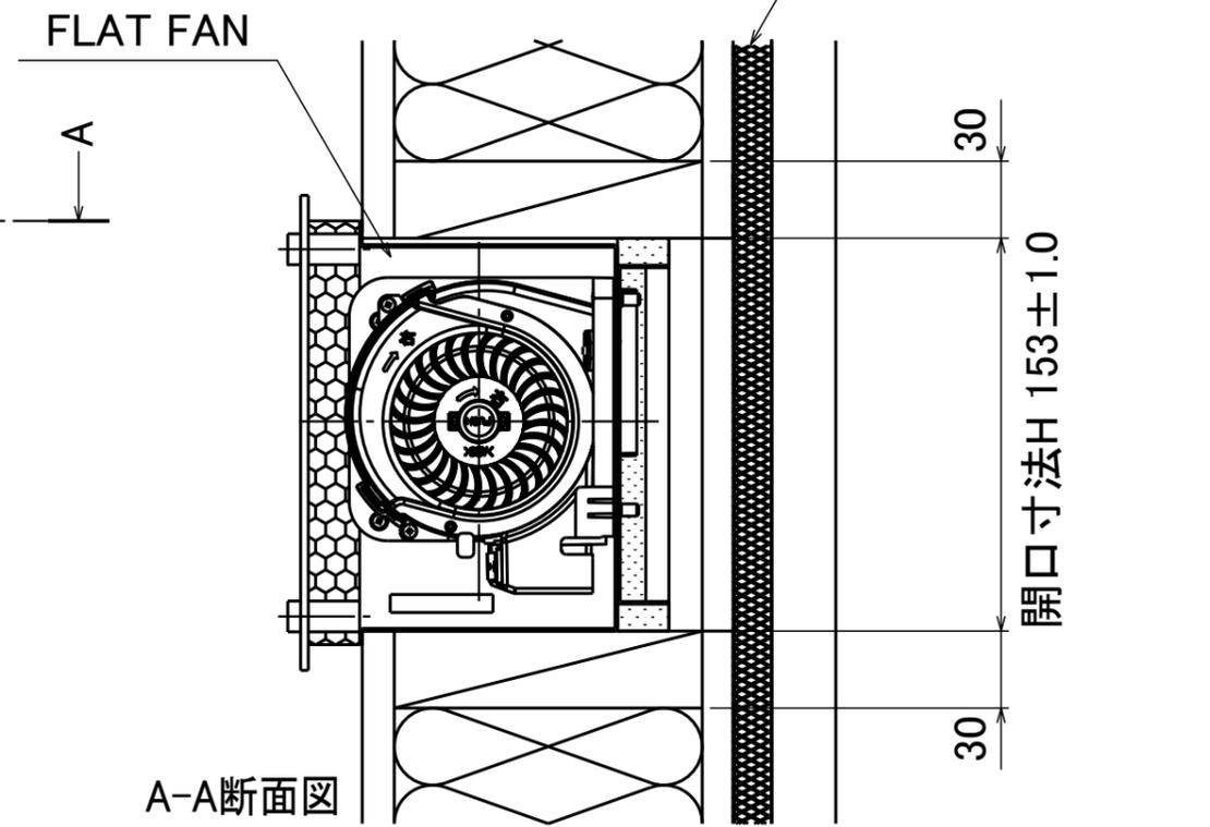
ZAA187-FB02 C FLAT FAN 縦胴縁納まり図 (柱120)
