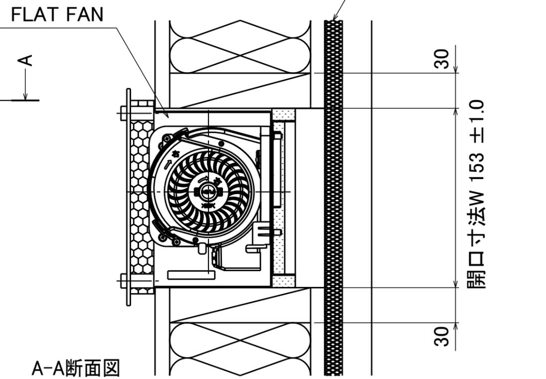
ZAA187-FB04 C FLAT FAN 横胴縁納まり図 (柱120)
