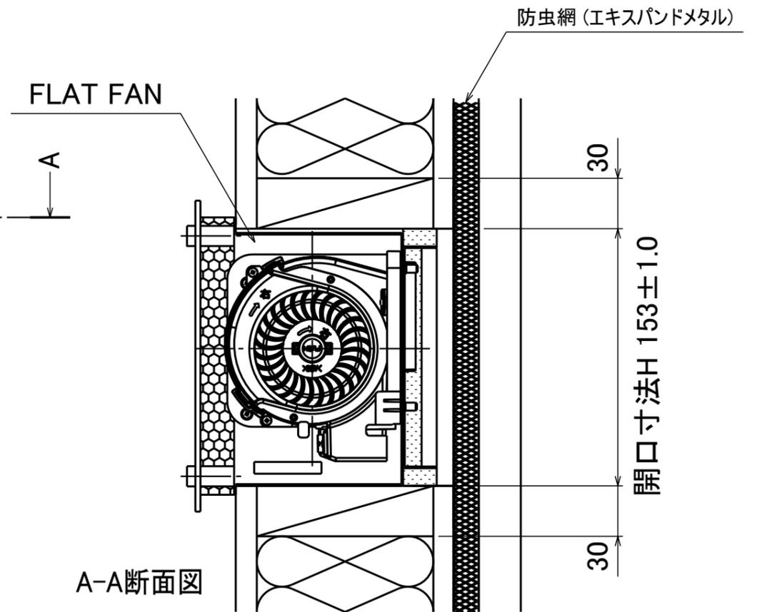
ZAA187-FB01 C FLAT FAN 縦胴縁納まり図 (柱105)
