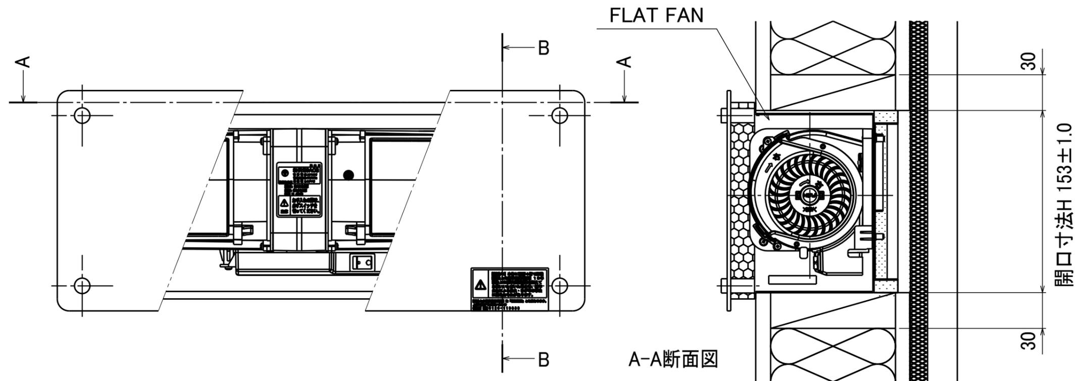
ZAA187-FB03 C FLAT FAN 横胴縁納まり図 (柱105)
